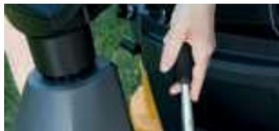
Das Mähwerk schaltet man einfach mit einem Hebel zu und wieder aus. Auch dies erfolgt einfach vom Fahrersitz aus.
