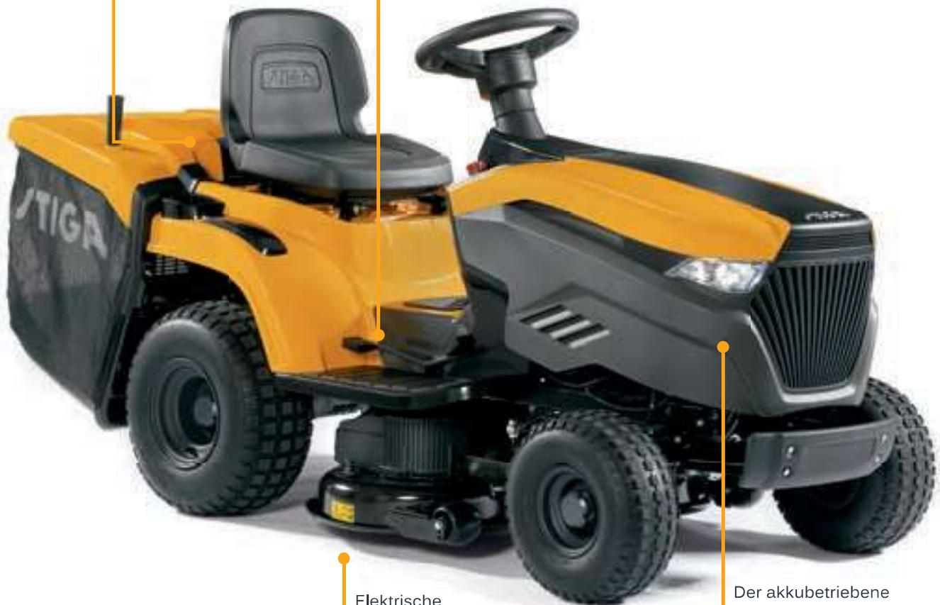
Elektrische Messermotoren gewährleisten Effizienz und Leistung beim Mähen
